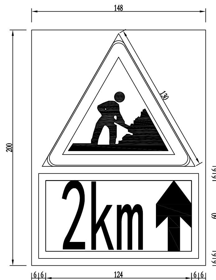
警告标志 施工+辅助标志
