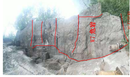
图 3.7 陡崖带卸荷裂隙形成危岩体
