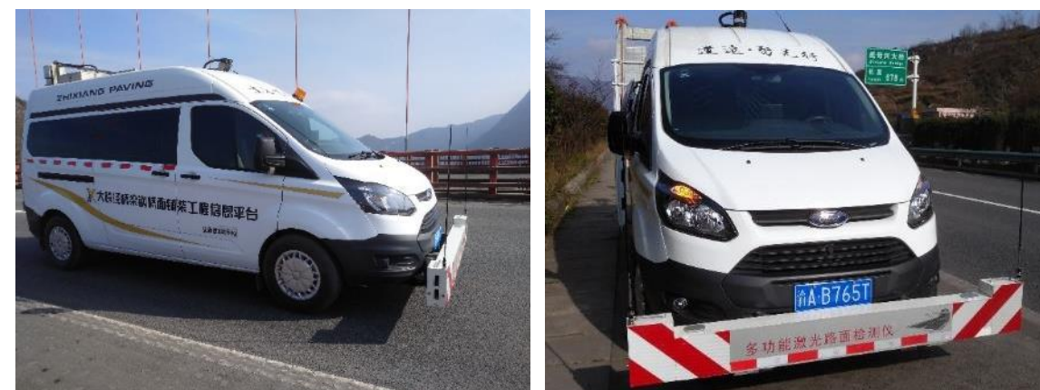
图 3.1-3 道路多功能检测车
