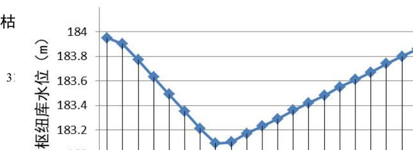
图 5.1.3-9 白马航电枢纽设计枯水年 10 月典型日库区水位过程图
