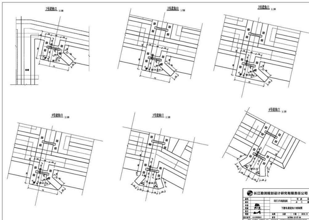
图 6.3.4-7 白马航电枢纽工程鱼道进鱼口设计图
