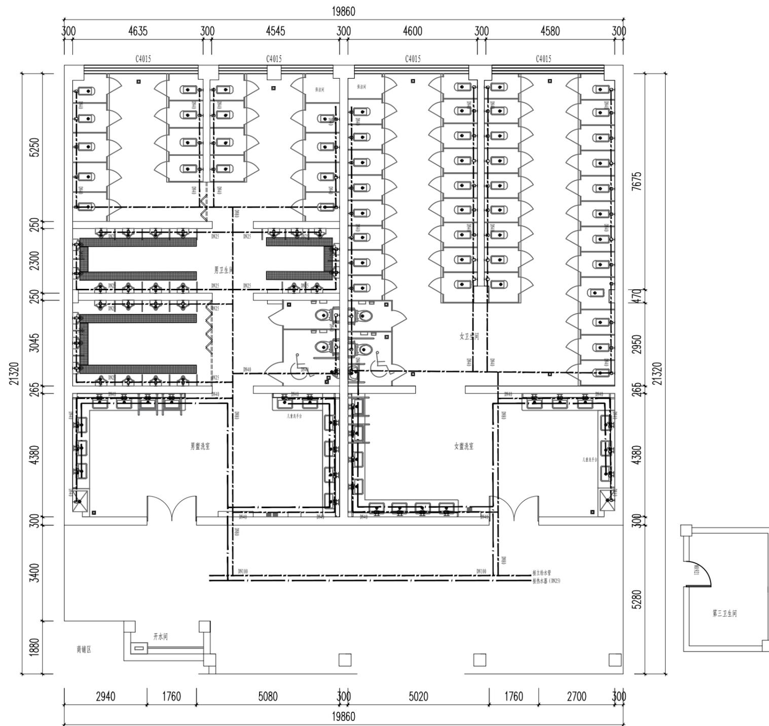
01 FURNISHING PAN 卫生间改造给水管径平面图 SCALE: 1: 60
