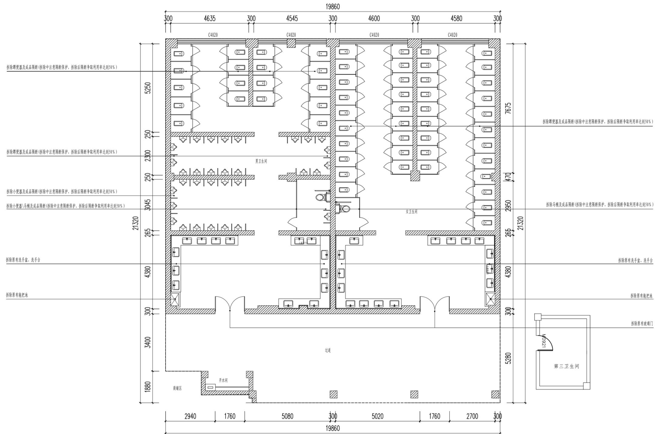
注: 卫生间隔断拆除后二次利用, 争取利用率达50% (考虑拆除损坏和尺寸原因预估此数据, 实际情况以现场发生为准)。
