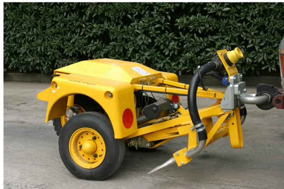
图 3.1-2 路面摩擦系数测试系统
