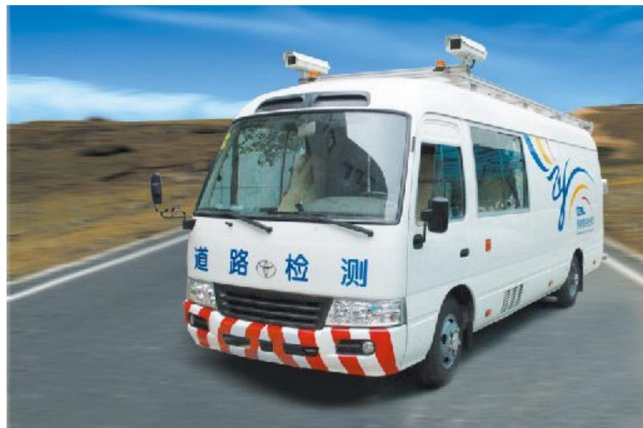
图 3.1-1 ZOYON-RTM 车载智能路面自动检测系统
