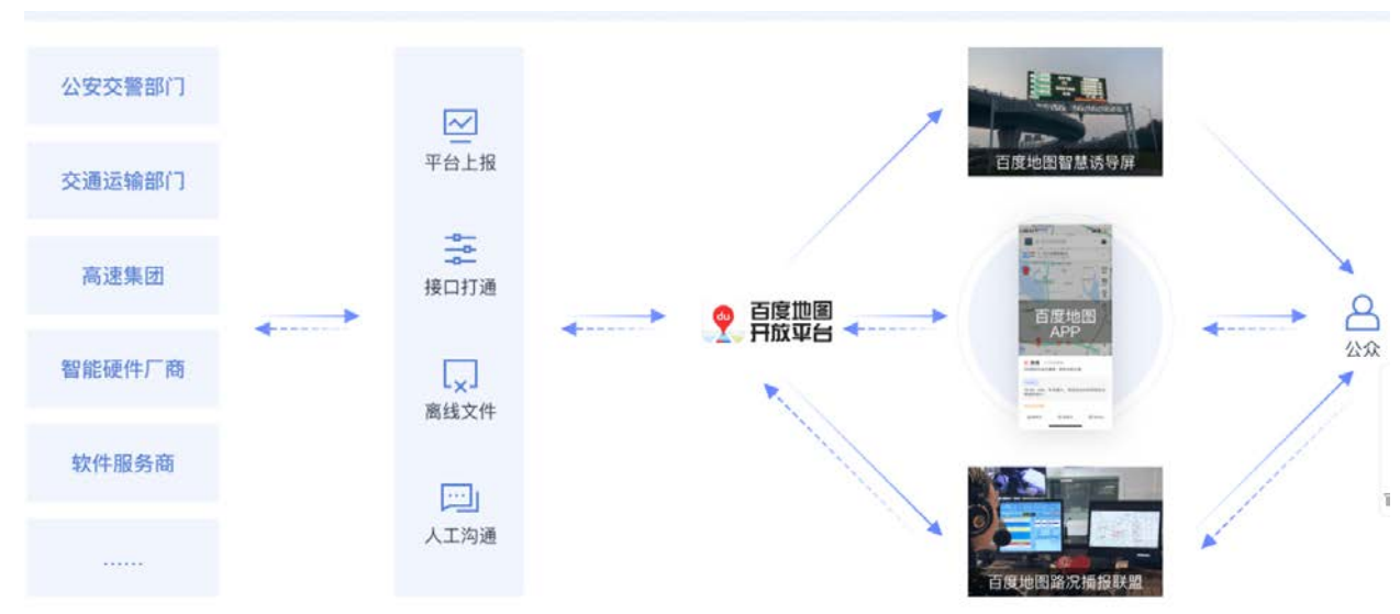
图 9-1 基于地图导航 app 的交通信息发布架构
