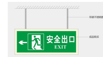
室内悬挂式安全出口指示图 标牌16
