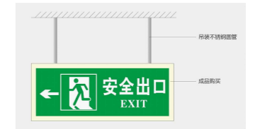
室内悬挂式安全出口指示图 标牌16
