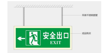
室内悬挂式安全出口指示图 标牌16
