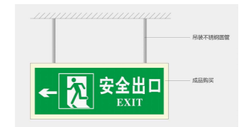
室内悬挂式安全出口指示图 标牌16
