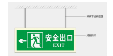
室内悬挂式安全出口指示图 标牌16
