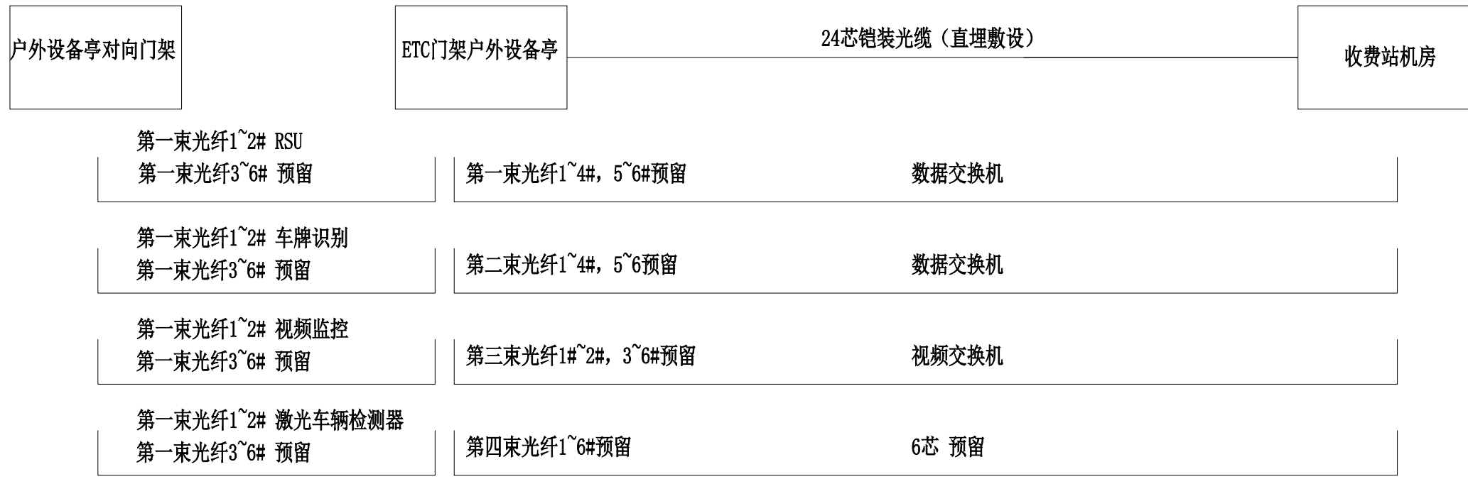
24芯光缆共计使用10芯，预留14芯 路段ETC门架光缆纤芯分配图
