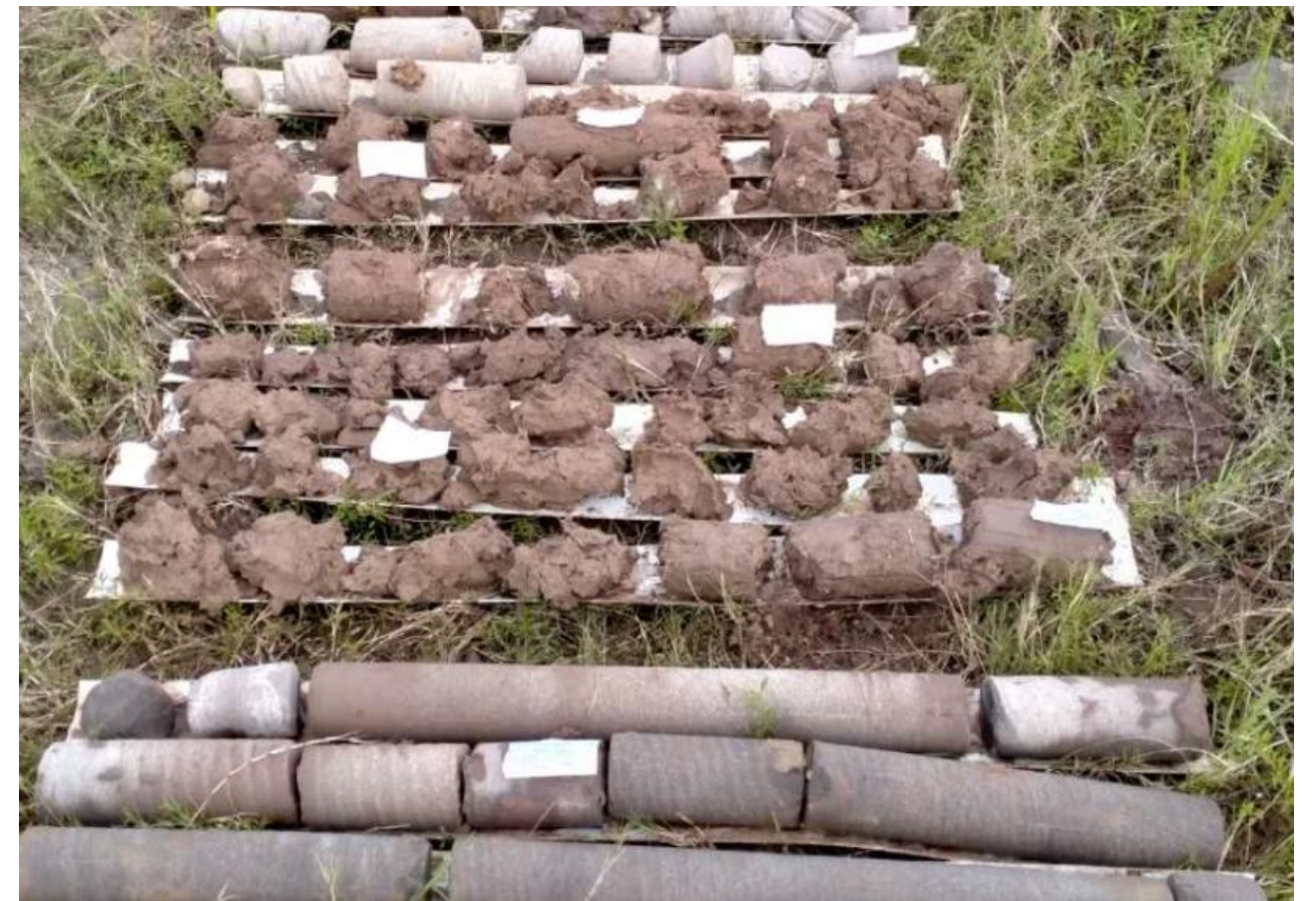
照片 4.3-1 滑塌区填土岩芯照
