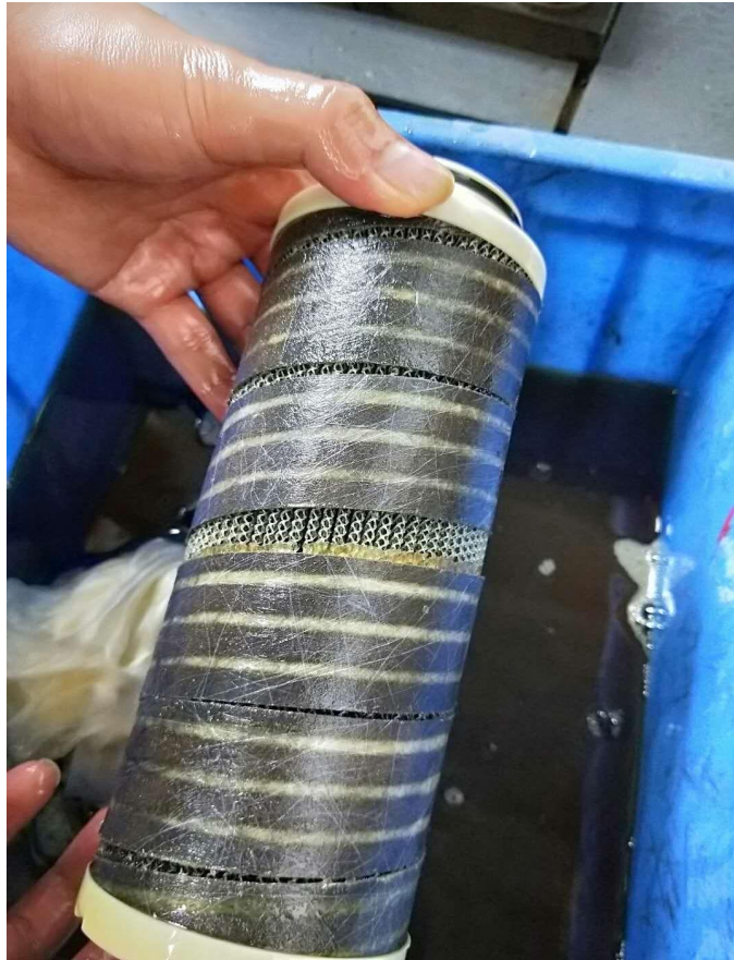
图 4：调速器滤芯更换
